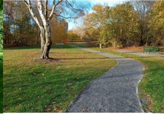
informele parkpaden, gestabiliseerde halfverharding type Stabilizer, kleur 'Hansa mix' (Ecodynamic) met opsluitbanden (uit het zicht)
